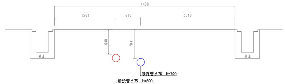
分岐B+P.5.0 (土工断面3)
