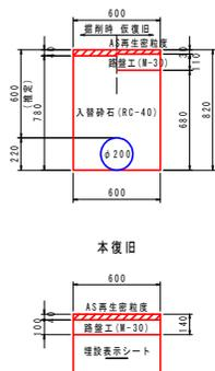
土工断面2 市道 車道 AS舗装(両切) H=1.0(推定) φ200
